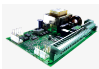
Vestavěná řídicí jednotka 624 BLD, tech. specifikace viz kap. Řídicí jednotky
