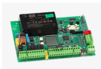
Řídící jednotka E145 S LC, technická specifikace viz kapitola Řídící jednotky 790306
