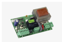
Vestavěná řídící jednotka 615 BPR, tech. specifikace viz kap. Řídící jednotky
