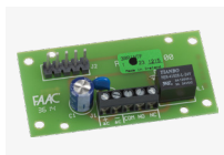
Relé interface pro RP přijímače (umožňuje použití RP jako exter- ního přijímače)
